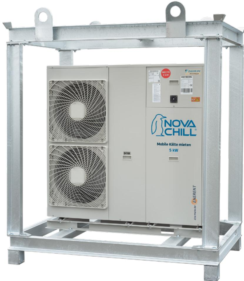
Luftgekühlter Mini-Kaltwassersatz mit Inverter. Inverter-Verdichter passen kontinuierlich die Verdichterdrehzahl an den tatsächlichen Bedarf an. Weniger energieverbrauchende Starts und Stops führen zu einem verringerten Energieverbrauch (bis zu 30%) und zu stabileren Temperaturen.
